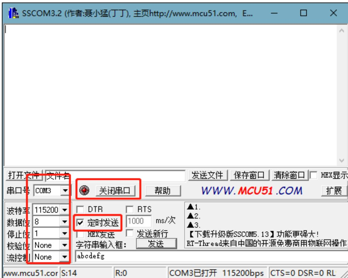
1、在 FCU3001 的 microcom 中输入字符，pc 工具能收到。用 PC 工具给 FCU3001 发送字符，microcom 中也能显示：
