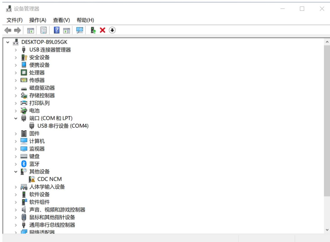
如上图所示串口编号为 COM4，通过 putty 打开该串口可以登录到 FCU3001，串口模式必须设置为 8N1，即 8bit 数据位，无校验位，1 结束位（READ-usb-dev-mode.txt 中对串口 8N1 解释有误）。
