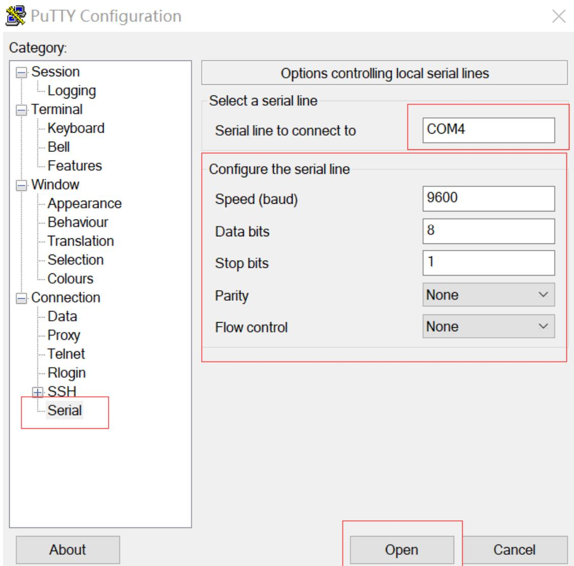
串口打印出系统配置的第一个界面：
