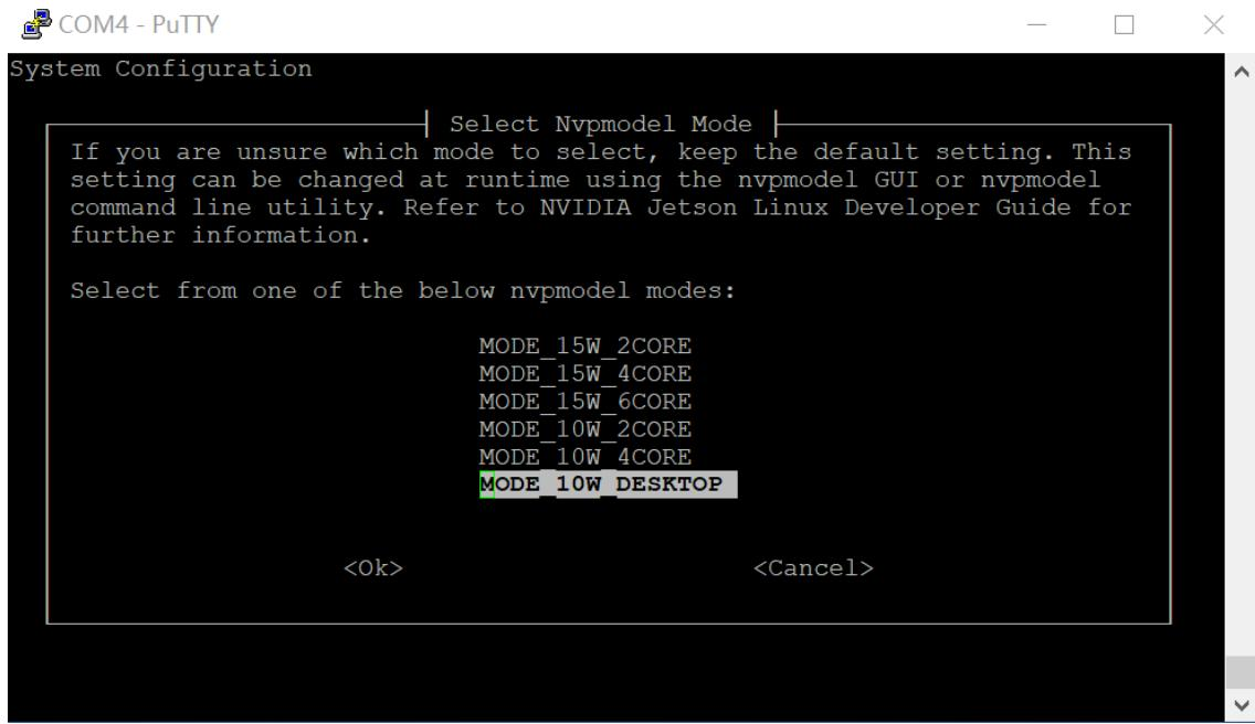
根据实际需求选择，最大功耗为 15W，大的功耗会带来更多的性能和发热，选择完成后按回车，系统开始自动配置：
