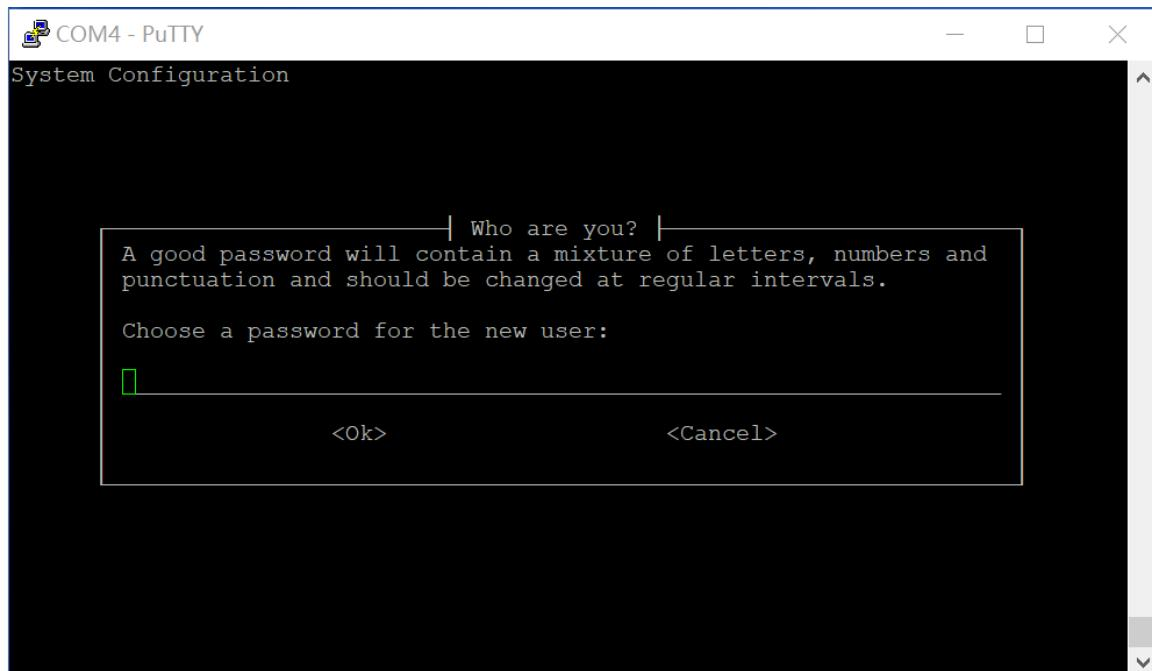
根据实际需要输入密码后，按回车，进入确认密码界面：
