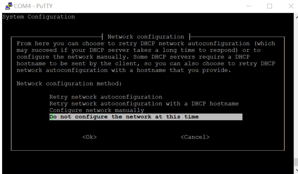
移动光标到最后一个选项，暂时先不配置网络（如有需求配置网络，在这界面选择 **Configure network manually**），输入回车到 **hostname** 设置界面：
