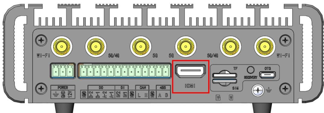
HDMI 支持自适应分辨率，最大支持到 4K 分辨率。
