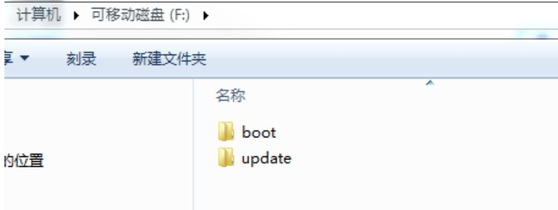
将 U 盘插入 USB3.0 的任意口，对 FCU3001 上电，自动开始刷机。数分钟后提示刷机完成。断电，拔下 U 盘，再上电。参考第一章首次启动重新配置系统。
