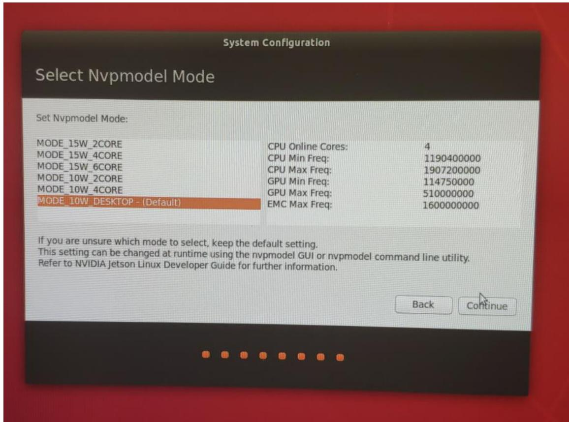
根据场景选着合理的电源管理模型， MODE\_15W\_6CORE 为最大功率，选择完成后点击“Continue”。
